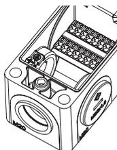
El interruptor dispone en su interior de un sistema de conexión por resorte tipo PUSH-IN. Esta tecnología permite un cableado sencillo y rápido, porque únicamente se tiene que insertar el hilo en el agujero correspondiente para establecer la conexión eléctrica. Este procedimiento se puede realizar sin necesidad de herramientas, utilizando hilos rígidos o flexibles con puntera. Los cables se sueltan presionando el pulsador.
