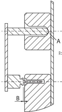
Al cerrar la puerta, el perno metálico se detiene en el fondo del bloque de centrado (A), antes de que el actuador pueda colisionar con la carcasa del interruptor, y deja una distancia de seguridad (B), que evita posibles daños.
