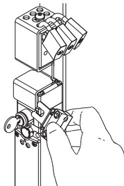
Un vez se ha accionado y bloqueado el dispositivo de lock out, el ojal para el actuador presente en el interruptor dejará de ser accesible.
