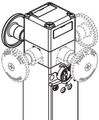
Los interruptores con bloqueo del actuador de la serie FG disponen de un pulsador de desbloqueo de emergencia, orientado hacia el interior de la máquina, permite que un operario atrapado involuntariamente pueda salir de la zona de peligro incluso en caso de producirse una caída de la tensión.
