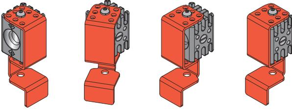
Con solo una acción, el dispositivo de lock out puede cerrar tanto el agujero de centrado como el ojal para el actuador presente en el interruptor, haciendo imposible el cierre mecánico de la puerta y la conmutación eléctrica de los contactos del interruptor.
