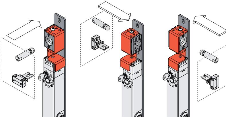
La forma simétrica del dispositivo de lock out permite utilizarlo en puertas batientes y correderas, tanto hacia la derecha como hacia la izquierda, manteniendo inalterada la función de centrado y la posibilidad de usar uno o más candados.
