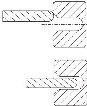
Gracias al centrado del perno en el bloque de centrado, ambos de acero inoxidable, se fuerza la alineación entre actuador e interruptor, garantizando así la correcta inserción sin colisiones.
