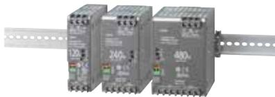
Fuentes de alimentación de alta potencia y economía de espacio, rendimiento de 93% reduce costos operativos. Tensión de entrada: 100 a 240V CA. Abrazadera para montaje en panel y para montaje en panel lateral. Se puede conectar a un carril DIN o directamente a una superficie del panel.
