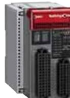
Ninguna programación requerida, el circuito de seguridad, se configura fácilmente a partir de las 8 o 24 lógicas preprogramadas. Cumple la norma de seguridad Categoría 4, SIL3 y PLe.
