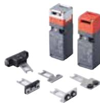
Función de detección de remoción de cabeza para desempeño seguro. La orientación de la cabeza se puede girar permitiendo 8 diferentes entradas de actuador. Disponible con metal resistente y durable y cabeza de conducto M20.
