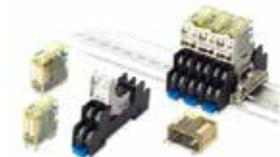
Relé guiado por fuerza para economizar costo y espacio de instalación. Mecanismo de Contacto guiado por fuerza (EN50205 Tipo A aprobado por TÜV). Aislación reforzada entre la bobina y los contactos de diferentes polos. Puede ser utilizada con el zócalo de relé serie SJ.
