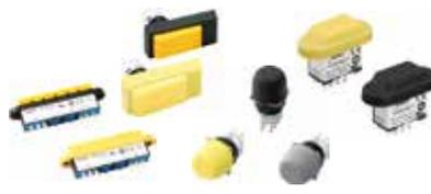
Puede ser utilizado para aplicaciones exigidas por la norma de robot de ANSI. Botonera de validación de 3 posiciones para evitar riesgos (OFF-ON-OFF). Maniobra de Apertura Positiva para la posición 2 (ON) y posición 3 (OFF). No enciende al ser liberado de la posición 3 posición 1.
