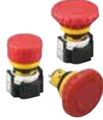
Alto nivel de seguridad, Estructura de Energía Inversa, Mecanismo de Seguridad (Safe Break) y Maniobra de Apertura Positiva. Empuje para Trabrar, girar para restablecer. Modelo de bloque de contacto removible: el primero E-stop del mundo con 4 contactos y Ø16mm tamaño compacto.
