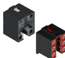
Bloques de contactos con tornillos imperdibles, protección de dedos y contactos con doble puente e interrupción doble para una mayor fiabilidad del contacto.
