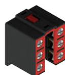
Bloques de contactos con tornillos imperdibles, protección de dedos y contactos con doble puente e interrupción doble para una mayor fiabilidad del contacto. Disponibles en distintas variantes con recorrido de accionamiento escalado, simultáneo o solapado, se adaptan a una amplia variedad de aplicaciones.
