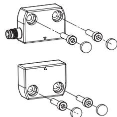
Todos los sensores y actuadores de la serie SR A se suministran con tapones de protección a presión para fijarlos en los agujeros de los tornillos de fijación. Estos tapones no solo evitan que se acumule suciedad y facilitan la limpieza, sino que también bloquean el acceso a los tornillos de fijación del actuador. Por eso, se pueden utilizar tornillos estándar en vez de tornillos antimanipulación.
