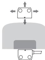
Por sus características intrínsecas, los sensores magnéticos disponen de una amplia zona de accionamiento que les hace ideales para su uso en resguardos imprecisos o resguardos cuyas características mecánicas pueden cambiar con el tiempo.
