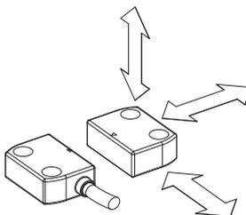
Los sensores magnéticos codificados están previstos para poder accionar el actuador correspondiente desde distintas direcciones. El cliente tiene entonces la máxima flexibilidad en el posicionamiento de los dispositivos en el perímetro de los resguardos.
