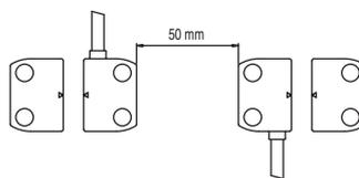
Es posible instalar varios dispositivos en la misma máquina. La distancia de montaje mínima entre sistemas sensor-actuador debe ser de 50 mm.
